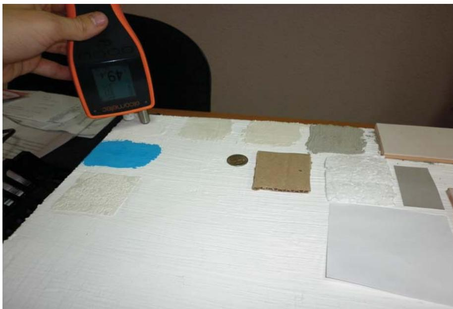
Рис. 1.2 — Измерение температуры на поверхности теплоизоляционного слоя Корунд®
