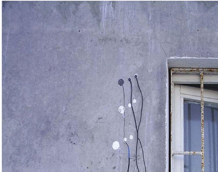
Рис. 4.2 — Измерение плотности теплового потока  $q$ , температуры поверхности  $t^{к/б}$  керамзитобетонной стеновой панели
